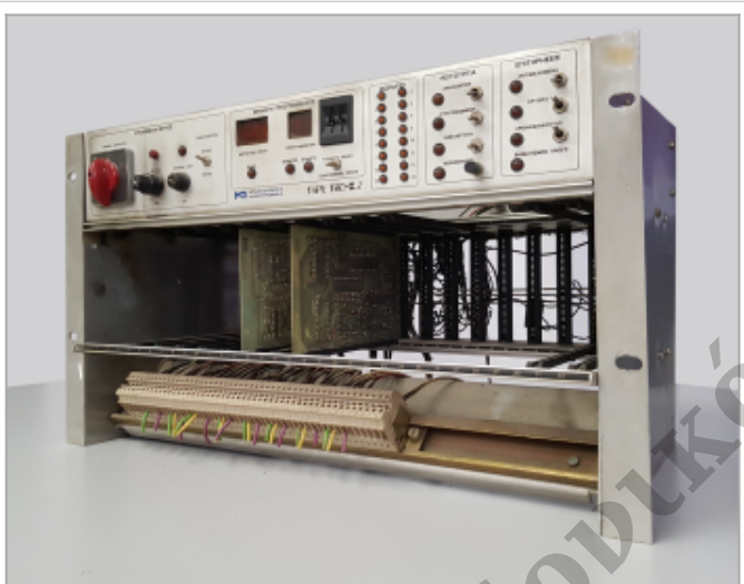
Ελεγκτής φωτινής σηματοδότησης κυκλοφορίας οχημάτων TRC-II.2
